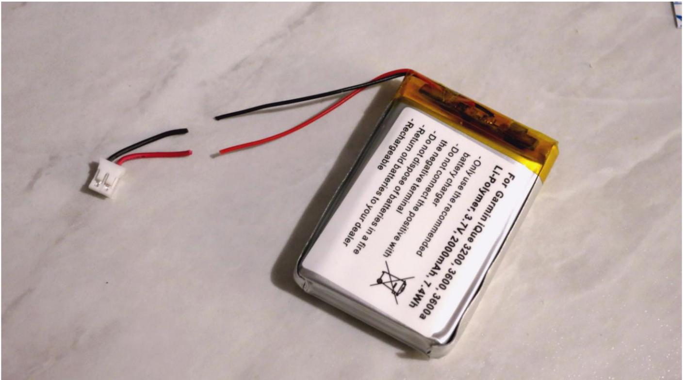
Schrumpfschlauch mit einem Schrumpfdurchmesser von ca. 1,5 mm ist dafür am besten geeignet.
