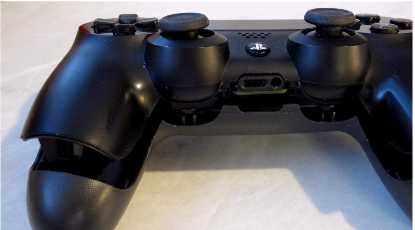
Den Spatel oder ggfls. auch Schlitzschraubendreher an dieser Stelle nicht zu tief einführen, um die Hauptplatine und die Buchse nicht zu beschädigen!
