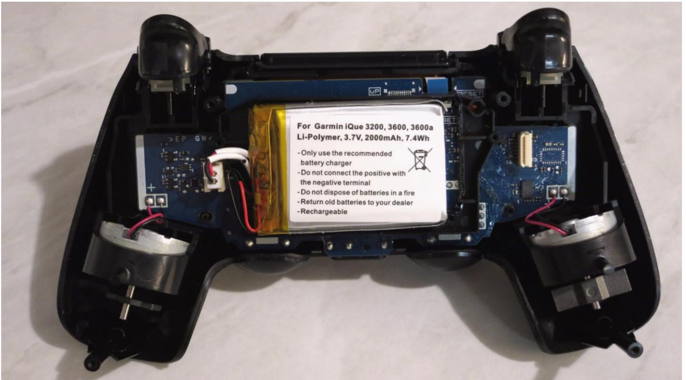
Das Folienkabel, wie gezeigt, mit der schlanken Spitzzange an der blauen Zunge festhalten und von oben einstecken. Den Reset-Nippel wieder in das quergeschlitzte Führungs-Loch stecken.
